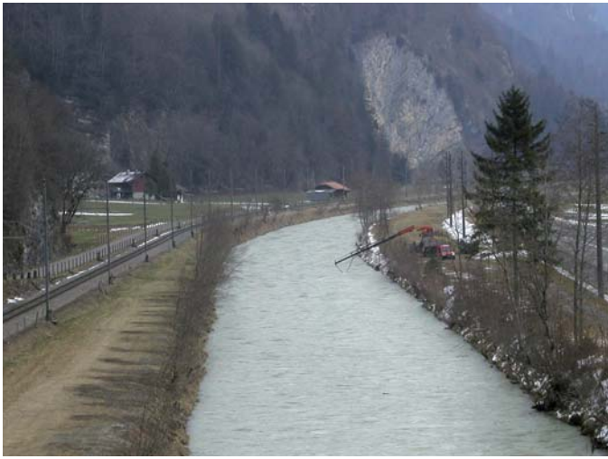
Bild 2. Driftversuche in der Aare im März/April 2008 (Limnex 2009). Links, Messung in unzugänglicher Kanalstrecke mittels Lastwagenkran, Tauchpumpe, Schläuchen, Netz und Bottich; rechts, Messung der Drift mit fixiertem Netz in der Kiesbankstrecke. Fotos Peter Baumann, Limnex AG.
