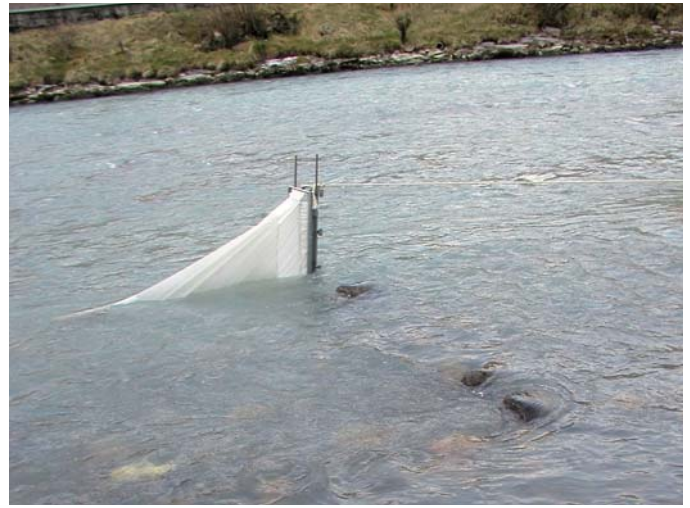
Bild 2. Driftversuche in der Aare im März/April 2008 (Limnex 2009). Links, Messung in unzugänglicher Kanalstrecke mittels Lastwagenkran, Tauchpumpe, Schläuchen, Netz und Bottich; rechts, Messung der Drift mit fixiertem Netz in der Kiesbankstrecke. Fotos Peter Baumann, Limnex AG.
