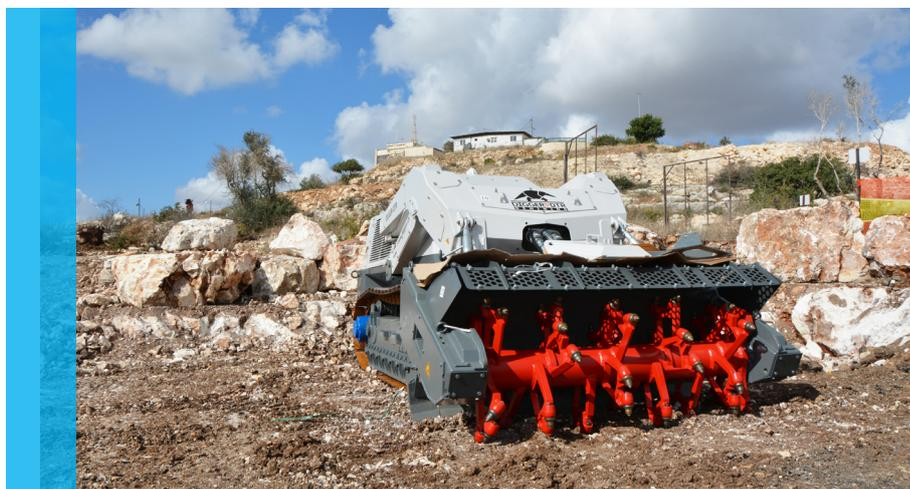
Minenräumungsgerät Digger D-250 (Bild: www.dtr-digger.ch)
